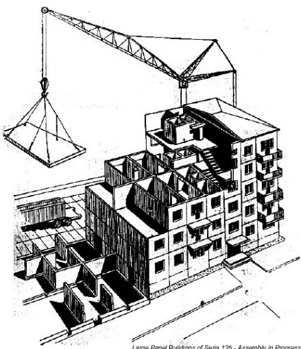
عایق حرارتی دیوارها از طریق استفاده از یک لایه ملات سیمان و پلی استایرن که در کارخانه به هنگام ساخت دیوارها بر روی لایه بیرونی دیوار خارجی اجرا می شود، تامین می شود. از آنجایی که ضربه انتقال حرارت بتن سبک از بتن معمولی کمتر است، لذا به نظر می رسد که عایق حرارتی این سیستم توسط لایه عایق حرارتی سیمان و پلی استایرن به همراه بتن سبک تامین می شود. این سیستم در طبقه بندی صرفه جویی زیاد در مصرف انرژی قرار داشته و در تمام مناطق ایران قابل استفاده است.
